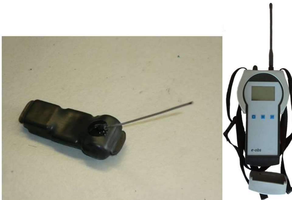
E-obs предавател и UHF приемник за сваляне на данните от предавателя
