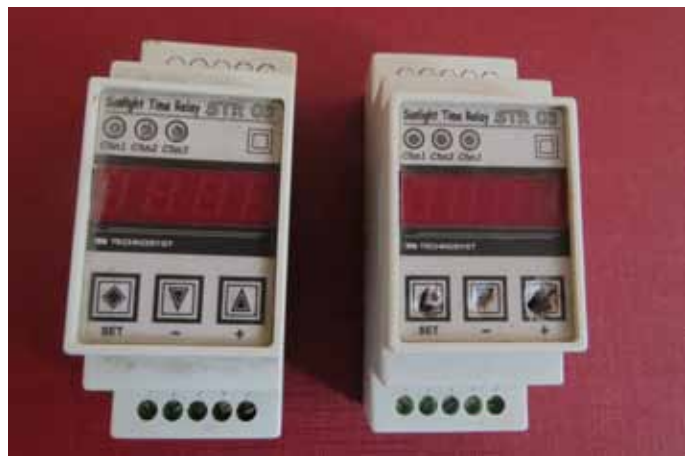
Вляво виждате здрав програматор, вдясно - пробития от крадците
