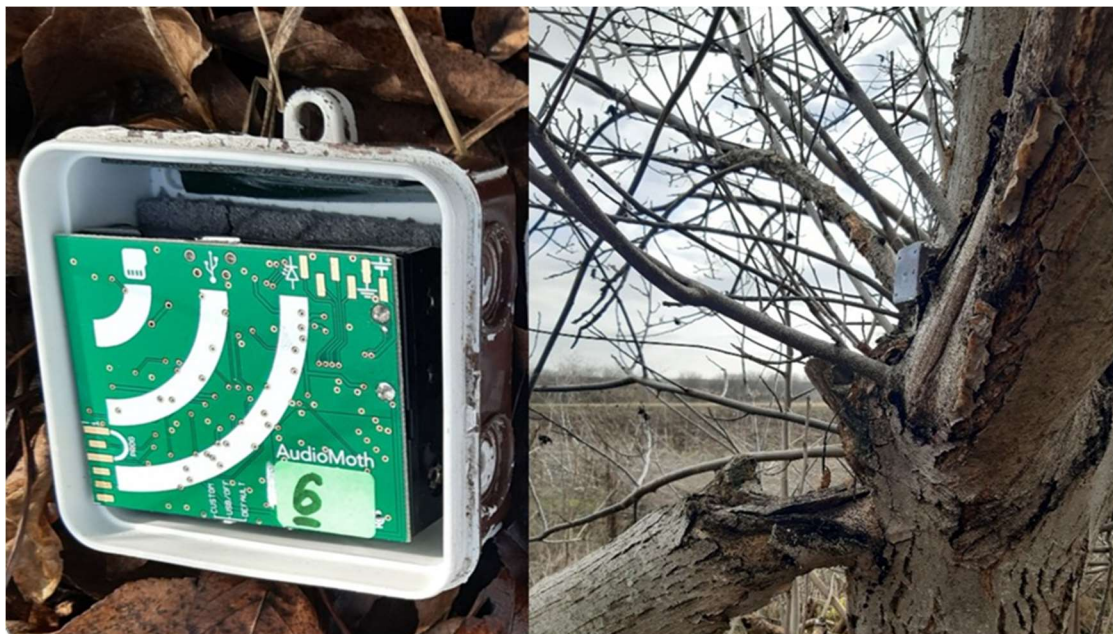
Фигура 2. Устройството AudioMoth и неговия водоустойчив корпус, адаптиран от електрическа дозаторна кутия (IP55) и водоустойчива акустична мембрана, поставена в кутията.
