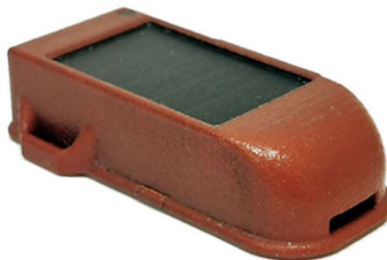
Фиг. 1: Типове GPS-GSM предаватели използвани за маркиране на гъски през 2022г.
