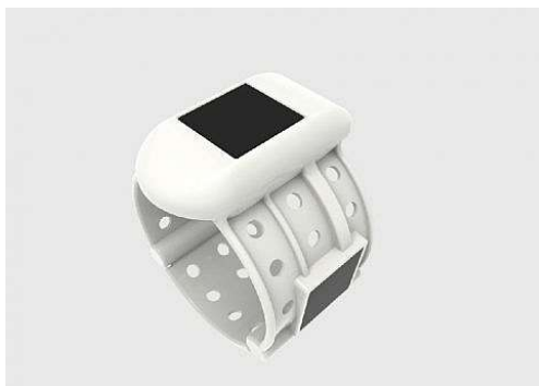
Фиг. 1: Типове GPS-GSM предаватели използвани за маркиране на гъски през 2022г.
